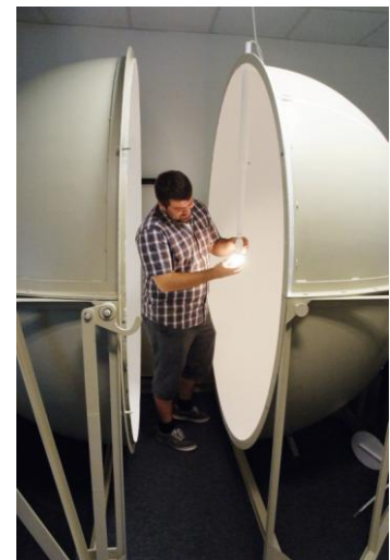
In der Ulbrichtkugel wurde die Helligkeit der Lampen geprüft.
